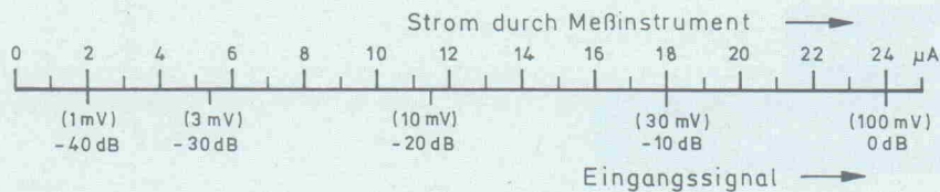
Bild 2. Skala des logarithmischen VU-Meters.
